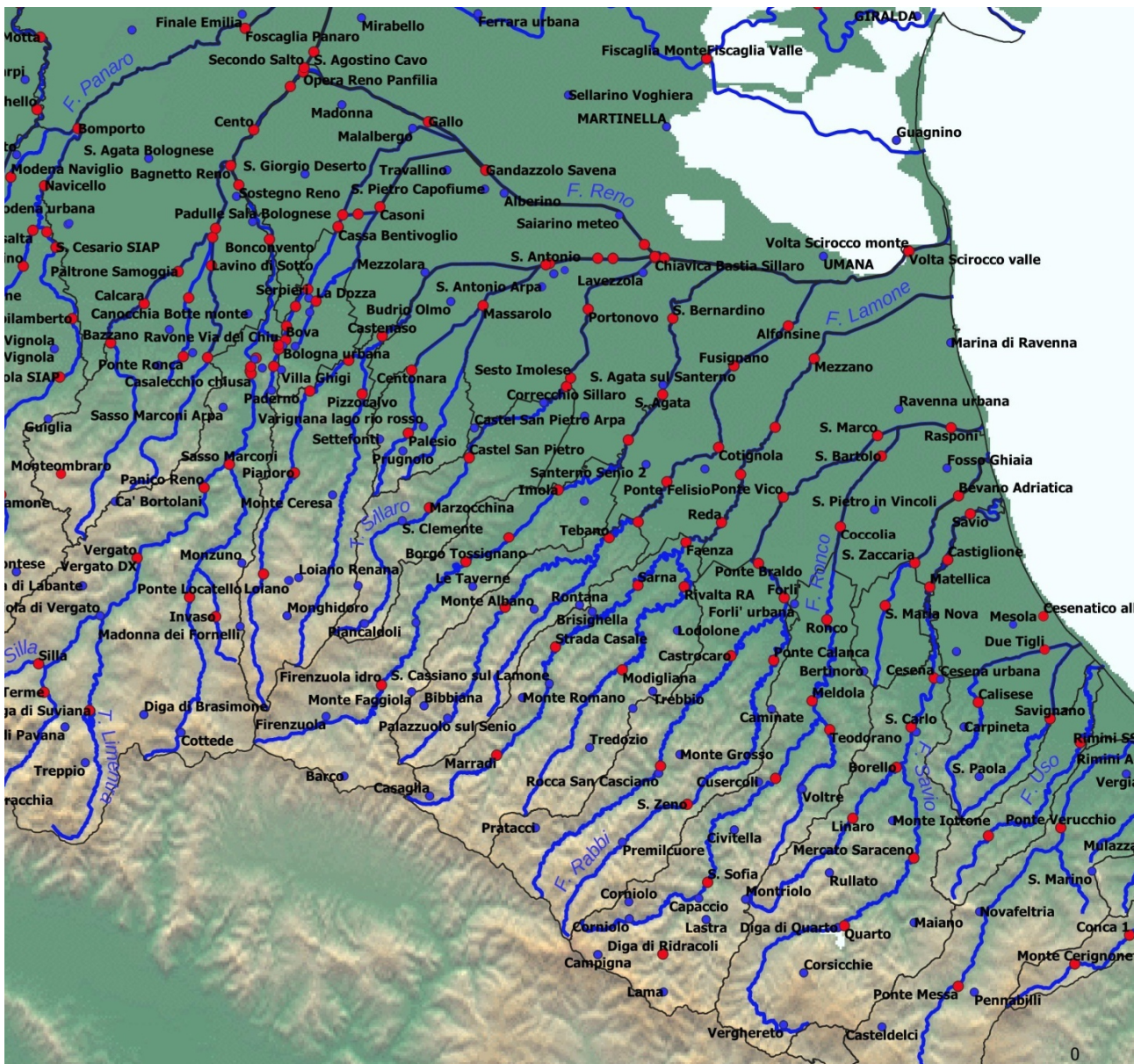
Figura 17: Bacini idrografici e relativi corsi d'acqua interessati dalle piene del 8-9 dicembre 2024, con l'ubicazione delle stazioni pluviometriche (in blu) e idrometriche (in rosso).
