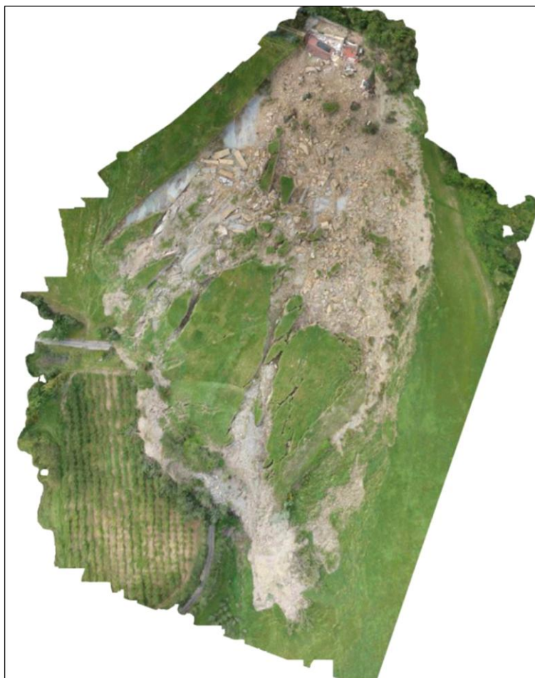
Figura 51: La frana di Raggi ripresa dal drone; nell'immagine sono ben visibili l'interruzione della viabilità di accesso all'omonima località e i blocchi sparsi di materiale lapideo presenti sul corpo di frana (foto Università di Bologna).
