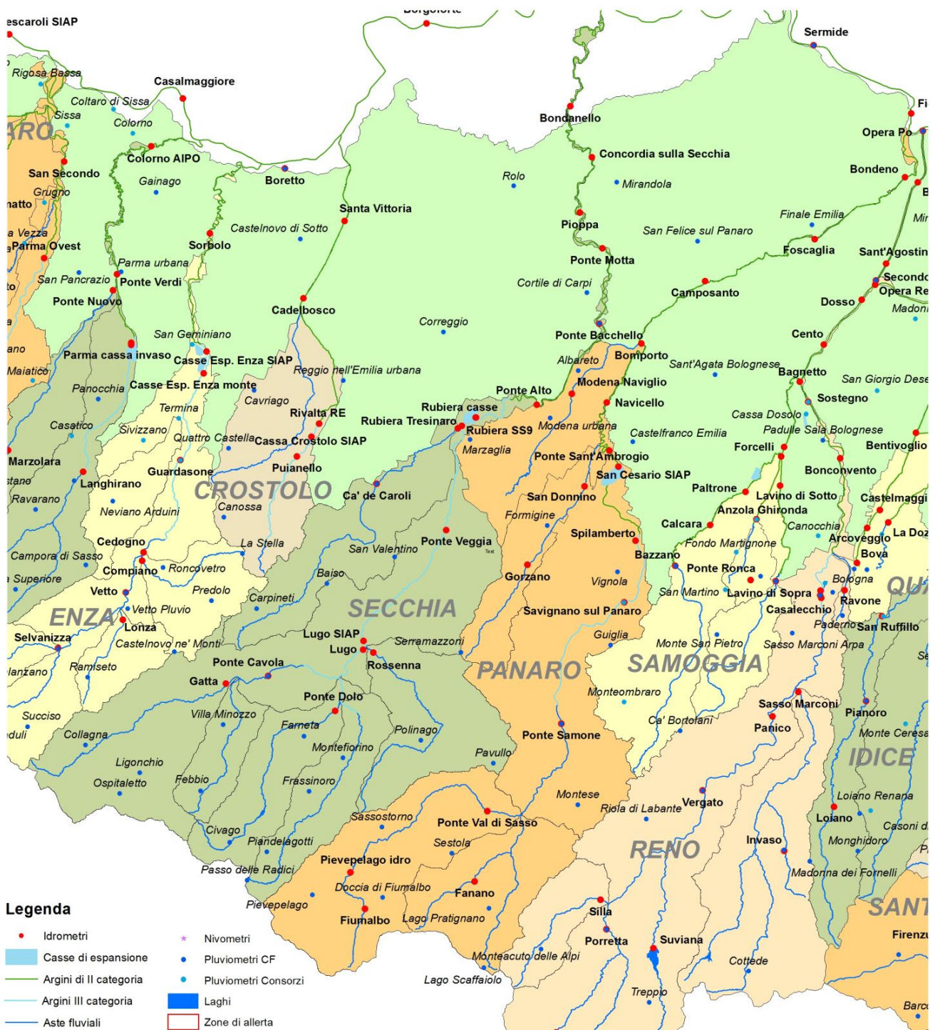
Figura 6: Bacini idrografici del Secchia, Panaro e Samoggia affluente di sinistra del Reno, con ubicazione delle stazioni idrometriche e pluviometriche di misura.
