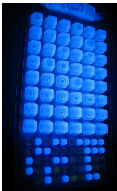
Figura 4: Metodo AFNOR IDX-33-04-02-15 Enterolert®- E dopo incubazione
