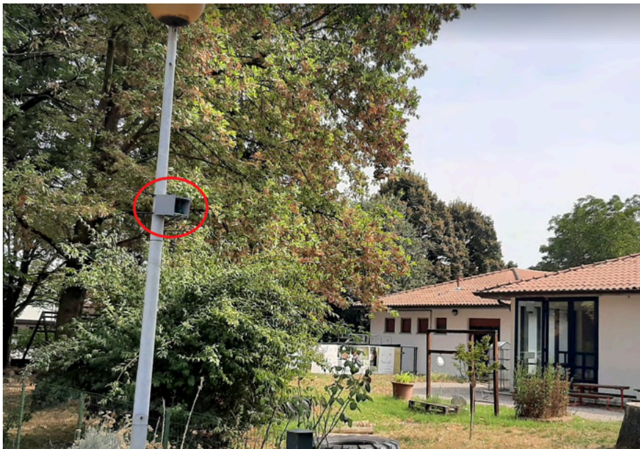
Campionatori passivi tipo Radiello installati presso Via Cervarolo
