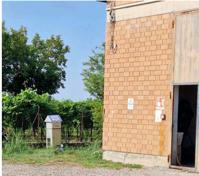
Campionatore ad alto volume per ricerca microinquinanti organici.
