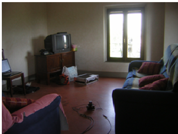
Figura 6 – Collocazione terna di accelerometri al secondo piano per misure di vibrazioni (PdM1)
