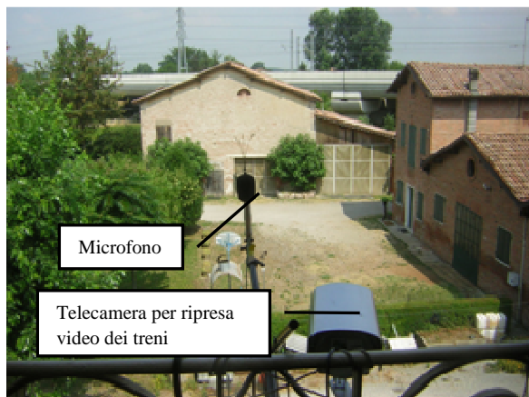
Figura 2 – Microfono per misura rumore e videocamera per ripresa video dei treni
