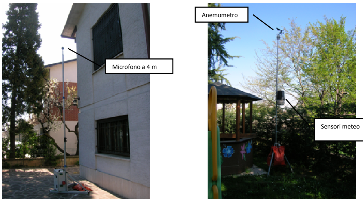
Figura 2 – Strumentazione per il monitoraggio acustico e stazione meteorologica
