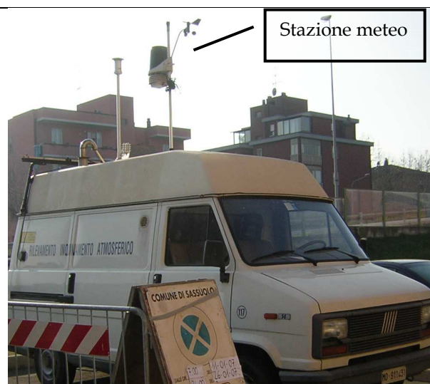
Figura 7 - Mezzo mobile e stazione meteo
