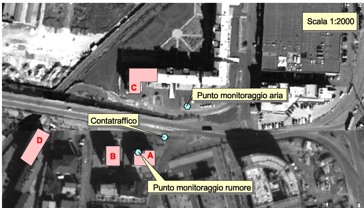
Figura 1 - Aerofoto dell'area in esame, punti di monitoraggio ed edifici più impattati dal traffico transigente sul cavalcavia
