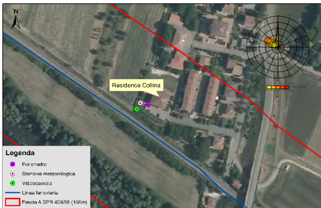
Figura 1 -Area monitorata e collocazione degli strumenti
