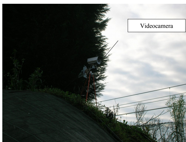
Figura 4: Videocamera per ripresa video dei treni
