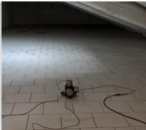
Foto 5: Terna di accelerometri
