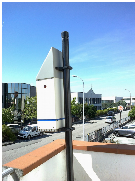
Cenralina PMM8055 posta sul balcone esterno
