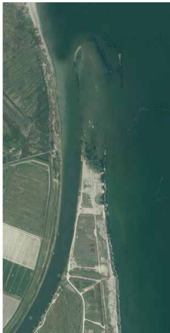
Figura 102 - Foce del Reno: in evidenza lo smantellamento, nel corso di tre anni, degli ultimi 700 metri della riva destra. A sinistra, ortofoto AGEA 22 Giugno 2008; a destra ortofoto AGEA 26 Maggio 2011.
