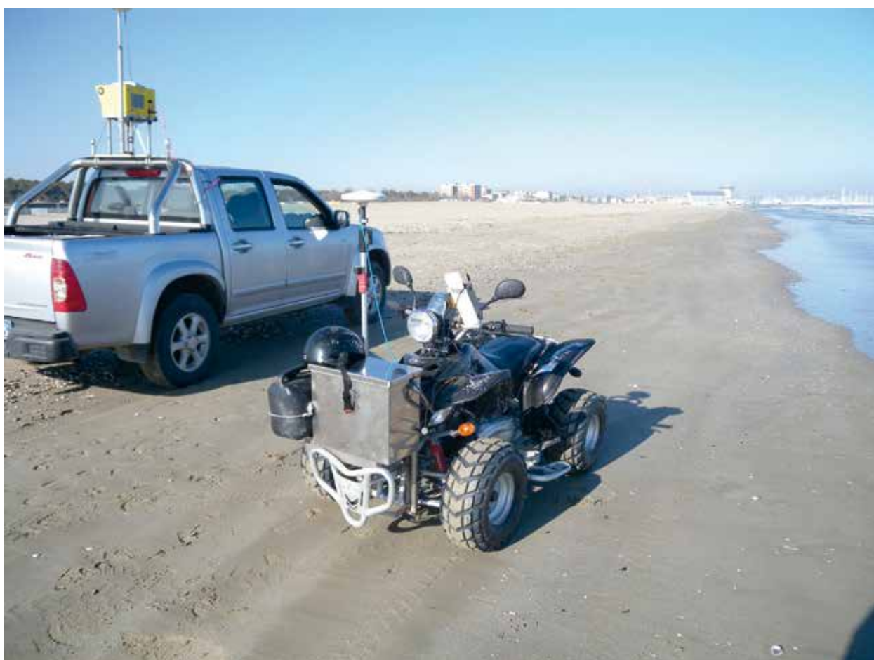
Figura 17 - Mezzi terrestri utilizzati per il rilievo della spiaggia emersa.
