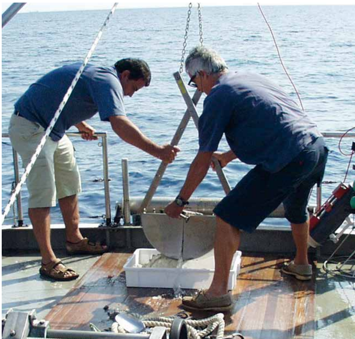
Figura 23 - Benna VanVeen nel momento in cui viene calata in acqua per effettuare il prelievo di un campione di sedimento.
