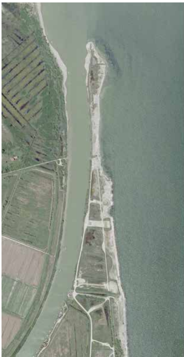
Figura 102 - Foce del Reno: in evidenza lo smantellamento, nel corso di tre anni, degli ultimi 700 metri della riva destra. A sinistra, ortofoto AGEA 22 Giugno 2008; a destra ortofoto AGEA 26 Maggio 2011.
