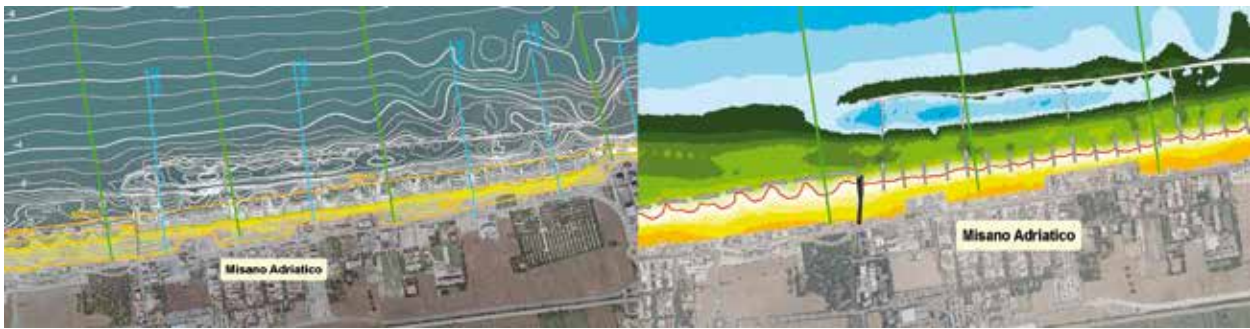
Figura 21 - Misano: confronto tra una carta topo-batimetrica a isolinee con una a scala di colori.
