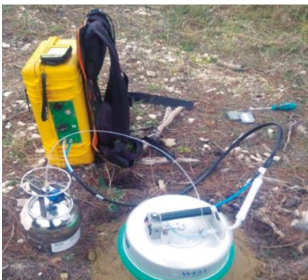
FIG.1 CAMERA AD ACCUMULO
