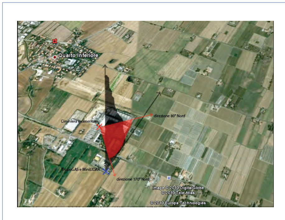
Fig.3.43 Mappa della zona di misura con segnate: a- (in rosso) il settore angolare favorevole per le misure proposte, b- (in nero) il piano verticale di scansione dello spettrometro.
