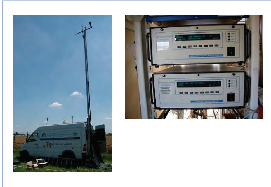
Fig.1.2 Fotografie della stazione micrometeorologica a 10m di quota e del contatore di nuclei ad essa collegato in cui è possibile osservare l'inlet della sonda di campionamento in quota.
