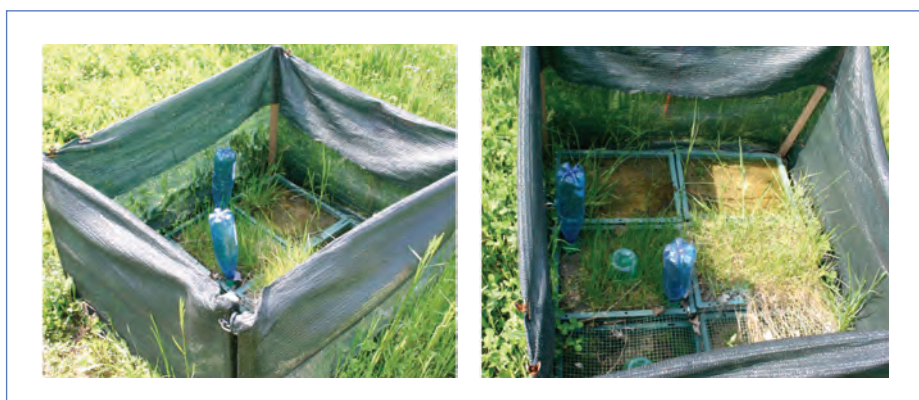
Fig. 4.2 Allestimento dei siti per valutare l'accumulo nel tempo di EPT per ricaduta atmosferica su soil technology e su vegetali assunti come bioindicatori.
