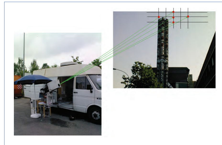
Fig. 3.11 Misure intorno la ciminiera con il MiniLIDAR dedicate alla ricostruzione del pennacchio in termini di polveri. I punti rossi dimostrano alcuni nodi della grilla virtuale dove si sono effettuate le misure.
