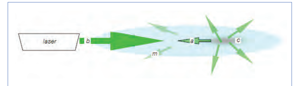
Fig.3.8 Il metodo LIDAR: La radiazione (b) emessa dalla sorgente (laser) propagando in atmosfera si diffonde a causa delle interazioni con le molecole (m) e con gli aerosol (a). La presenza di maggiori concentrazioni degli aerosol (c) lungo il percorso ottico della radiazione comporta un aumento della retrodiffusione (a) oggetto dell'interesse per il metodo LIDAR.
