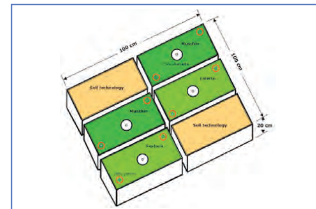
Fig. 4.1 Rappresentazione schematica dei contenitori predisposti per valutare l'accumulo nel tempo di Elementi potenzialmente tossici (EPT) per ricaduta atmosferica su “soil technology” e su vegetali assunti come bioindicatori
