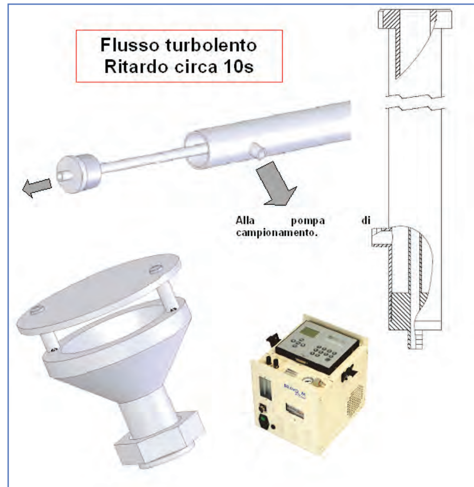
Fig. 1.4 Schema del sistema di aspirazione delle particelle collegato alla stazione micrometeorologica.
