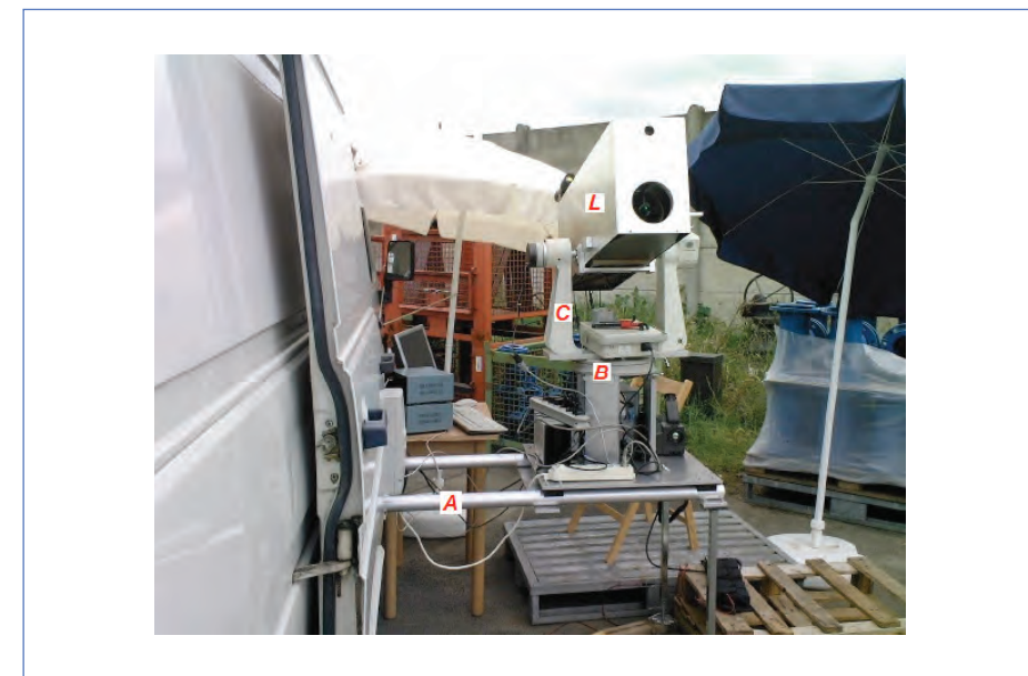
Fig. 3.10 La struttura componibile: A-binari smontabili, B-meccanismo per movimenti azimutali, C-meccanismo per movimenti zenitali, L-LIDAR.
