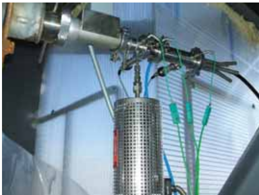
Foto 8. particolare del rack ospitante ELPI e unità di controllo FPS con protezione per gli agenti atmosferici
