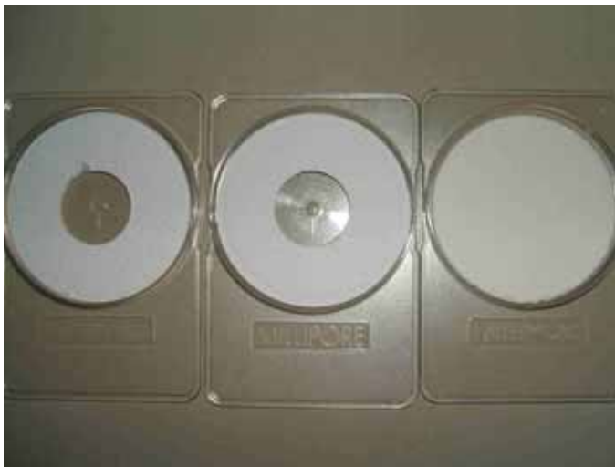
Foto 9 filtri relativi ai tre stadi dell'impattore dopo il primo campionamento di prova
