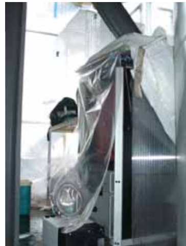
Foto 8. particolare del rack ospitante ELPI e unità di controllo FPS con protezione per gli agenti atmosferici
